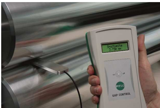
Abb. 2 GAP CONTROL zur Spaltmessung zwischen Walzen und festen Kanten
