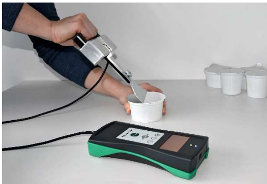
Abb. 1: PEEL CONTROL u. a. zur Messung von Öffnungskräften gesiegelter Verpackungen
