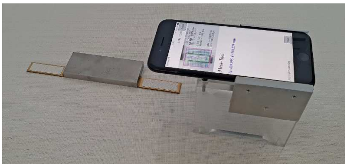
Bild 2: System zur Bestimmung der Abmessungen und Formhaltigkeit großer flächiger Objekte
