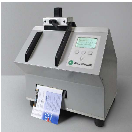
Bild 1: Das Klebebindungsmessgerät BIND CONTROL wird bei der Druckerei Vettors für die Bestimmung der Restfestigkeit im Falz genutzt
