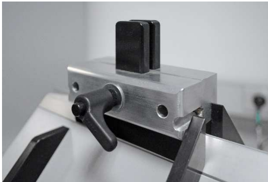
Bild 2: Die gemeinsam mit der Druckerei entwickelte Vorrichtung zum Klemmen der Muster
