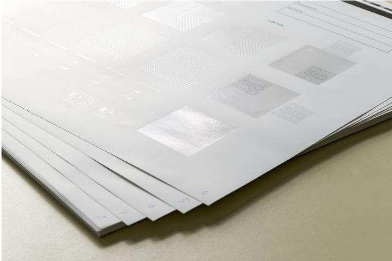
Bild 3: Testbogen zur Lackpassermessung
