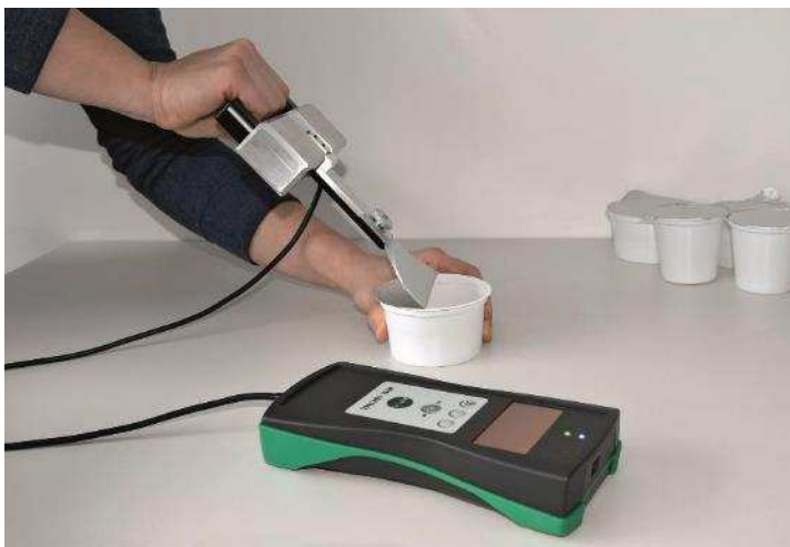
Bild 1: Das Trennkraftmessgerät PEEL CONTROL zur schnellen und einfachen Messung der Öffnungskräfte von Verpackungen
