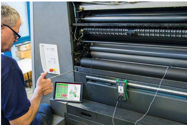
Bild 2: Einfache Einstellung der Kontaktstreifenbreite mit sofortiger Anzeige des aktuellen Werts
