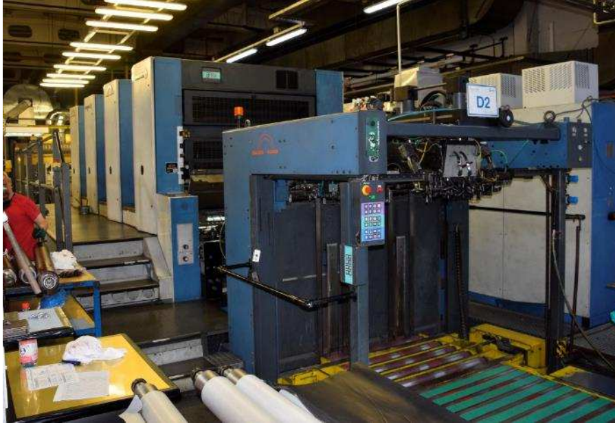
Bild 1: Eine der beiden Blechdruckmaschinen, die sich bei SILGAN Metal Packaging in Meißen im Einsatz befinden
