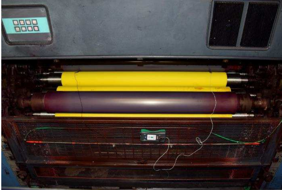
Bild 3: Mit den beiden Sensoren, die sich zwischen den Walzen befinden, werden Beeinflussungen auf die Messwerte sofort erkannt
