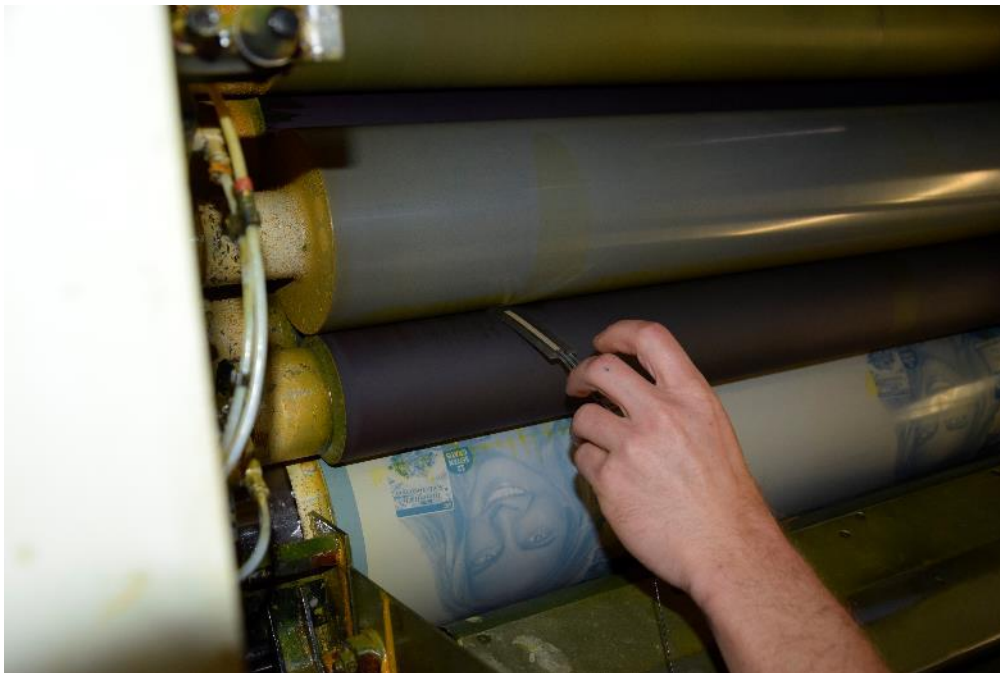
Bild 1: Einführen der handlichen Sensoren zur Kontaktstreifenmessung
