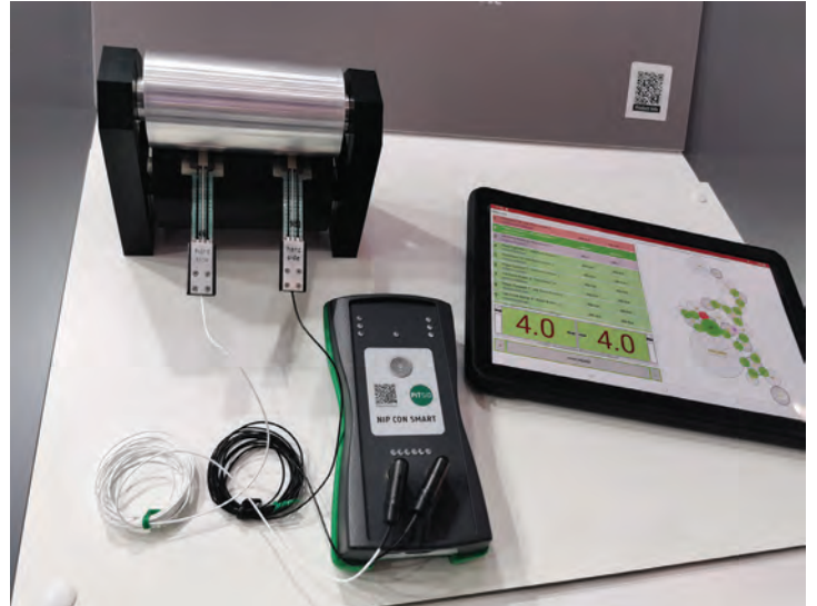
NIP Con Smart with visualisation of the test results NIP Con Smart mit Visualisierung der Prüfergebnisse
