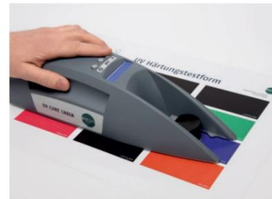
Das UV-Härtungs-Prüfgerät UV CURE CHECK ermittelt in kürzester Zeit den Aushärtungsgrad von UV- und Hybridfarben oder UV-Lacken durch die Bestimmung des Gleitreibungskoeffizienten. Sein Einsatzort ist der Messtisch, der Stapel oder das Farbsteuerpult, wo es nicht nur in Volltonflächen, sondern im normalen Druckbild per Knopfdruck aussagekräftige Werte ermittelt.
