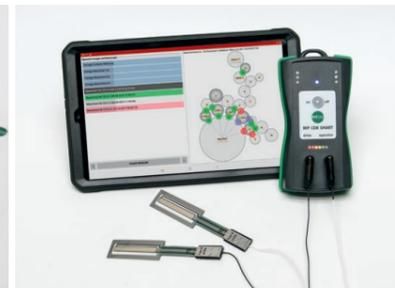
Das Kontaktstreifen-Messsystem NIP CON SMART dient zur exakten Bestimmung der Kontaktstreifenbreite (NIP-Breite) zwischen harten und elastischen Walzen. Es ist damit ideal zur Kontrolle und Korrektur der Einstellung von Feucht- und Farbwerkswalzen in Druckmaschinen geeignet. Auch für andere Walzenpaarungen in Verarbeitungsmaschinen ist das Gerät entsprechend der Spezifikation einsetzbar.
