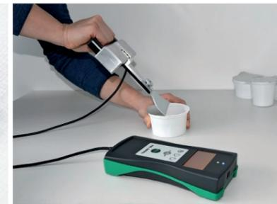
Das Trennkraft-Messgerät PEEL CONTROL dient zur Messung von Öffnungskräften peelbarer, durch eine Siegelnaht verschlossener Verpackungen oder von Trennkraften miteinander verklebter, verschweißter oder laminiertes Materialien.
