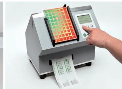
Das Klebebindungs-Messgerät BIND CONTROL dient zur Messung und quantifizierbaren Bewertung der Ausreißfestigkeit einzelner Seiten aus Buchblocks. Es ist das erste Gerät, das mit zugeschnittenen Buchblocks einheitlicher Breite misst.
