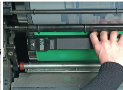
Das Aufzugs-Messgerät AMG ist für beliebige Zylinderdurchmesser geeignet und wird in den Größen S, M und L angeboten. Es misst selbst bei schlechter Zugänglichkeit im Handumdrehen die Höhe des Gummütuches oder der Druckplatte über dem Schmitz- beziehungsweise Messring und zeigt diese digital an.
