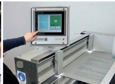
Mit der automatischen Druckplattenbiege APB wird das Abkanten der Druckplatte auf die Position des Druckbildes bezogen, unabhängig von den Maßschwankungen der Druckplatte. Dadurch wird eine präzise und achsparallele Lage des Druckbildes auf dem Sleeve oder Druckzylinder nach dem Einhängen der Druckplatte erreicht.
