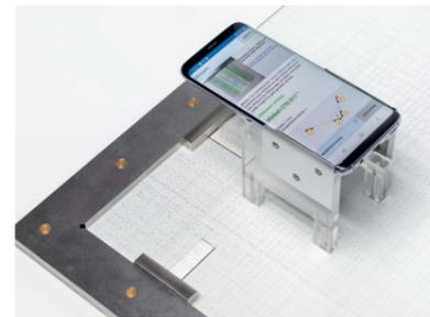
Das 2D-Messsystem MICRO CONTROL ist ein innovatives System zur präzisen Vermessung vorrangig (dünner) flächiger Objekte. Mit einfachster Handhabung lassen sich Abmessungen und Formen von Artikeln verschiedener Größe mit einer Auflösung im  $\mu\text{m}$ -Bereich ermitteln – auch von extrem dünnen Objekten, wie Papier, Karton oder transparenten Gebilden.
