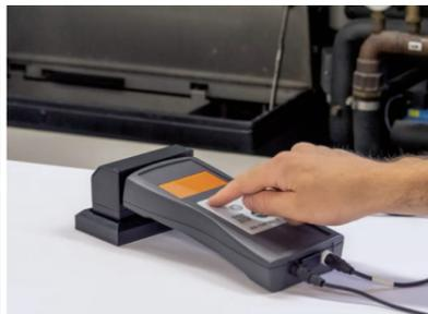
Mit dem IPA-Handmessgerät IPA CONTROL III ist eine schnelle, einfache und sehr exakte Bestimmung der Alkoholkonzentration im Feuchtmittel möglich. Das zu prüfende Feuchtmittel kann an allen zugänglichen Stellen im Feuchtmittelsystem entnommen und geprüft werden.
