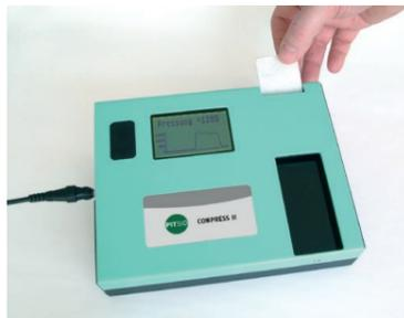
Das Pressungs-Prüfgerät CONPRESS II hat sich in Montage und Service von Druckmaschinen bestens bewährt. Es dient zur Prüfung der Anpresskraft von Schmitzringen durch den Vergleich der ermittelten Istwerte mit hinterlegten Sollwerten.
