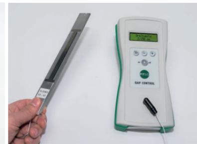
Das Spalt-Messgerät GAP CONTROL ist eine technische Innovation, die den Arbeitsalltag in der Maschinenmontage erleichtert. Es wurde entwickelt, um typische Abstände ab 1,8 mm zwischen Walzen oder Zylindern der Paarung hart/hart präzise zu ermitteln. Gleichzeitig kann mit dem Gerät die Breite von Spalten oder Schlitzen in mechanischen Bauteilen bestimmt werden.
